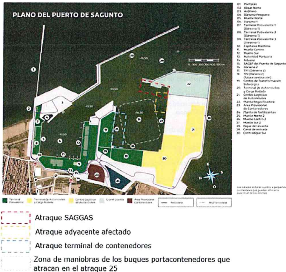
Figura 3: Afecciones de la presencia de dos buques abarloados a terminales adyacentes
