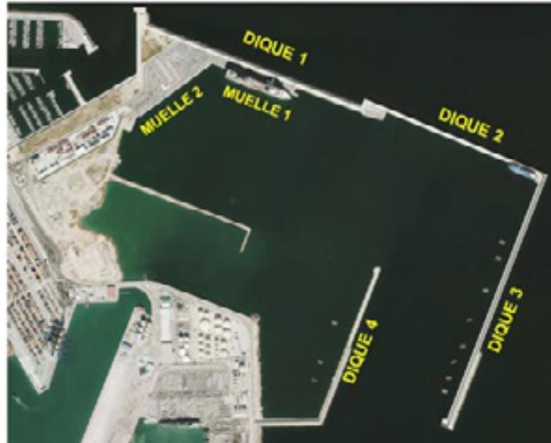
Ilustración 10. Estado actual de la ampliación norte del puerto de Valencia
