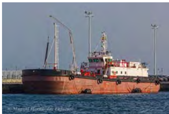
Gabarra "SOBIA" que opera actualmente en el puerto para realizar bunkering de fuelóleo y gasóleo a buques.
