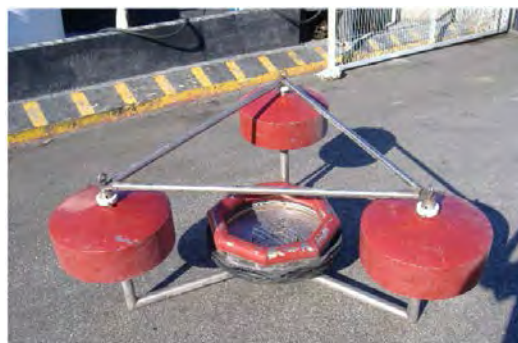
Skimmer portátil de rebosadero con una capacidad mínima de recuperación de 5 m 3 /h.
