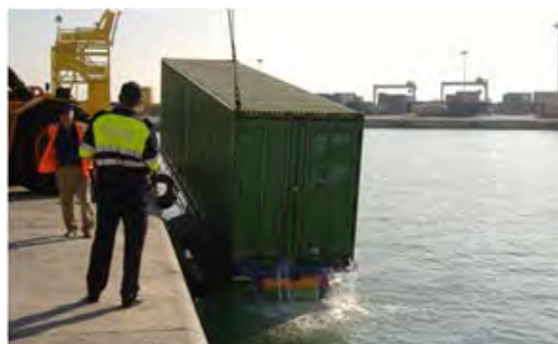
Extracción de una plataforma con contenedor caída al agua desde el muelle
