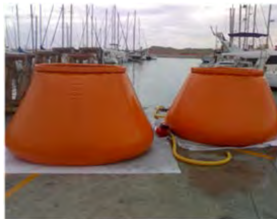
2 tanques autoportantes de 5 m 3 de capacidad
