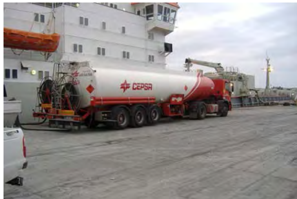
Operación de suministro de gasóleo a buque mediante camión cisterna..
