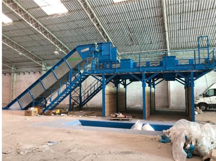
Figura 3 Ejemplo alimentador y plataforma de triaje. Fuente: Garbaport
