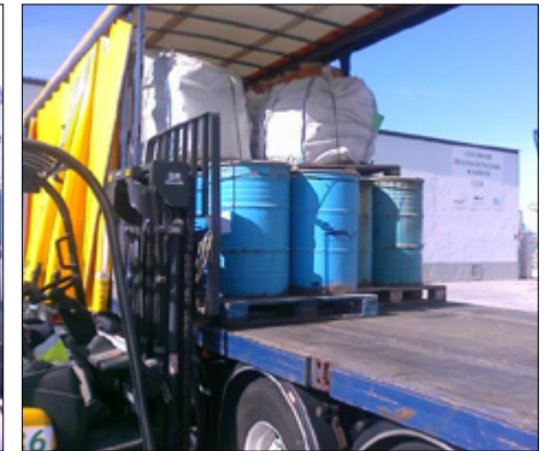
Detalle de trabajos de carga de los recipientes que contienen RP's al tráiler que posteriormente será descargado en una planta de destino final.
