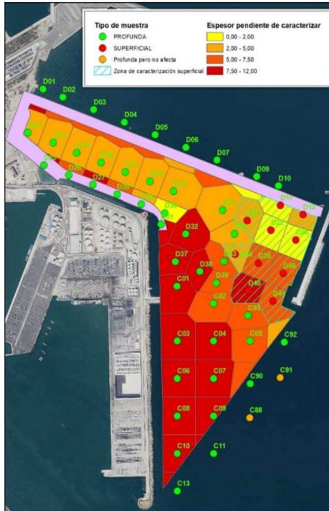
Figura 11. Superficies y espesores sin caracterizar, en el dragado previsto en el Puerto de Valencia. Fuente: Proyecto.
