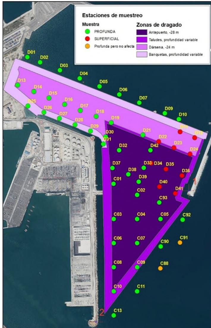
Figura 10. Ubicación de los puntos de muestreo y zonas a dragar en el Puerto de Valencia. Fuente: Proyecto.
