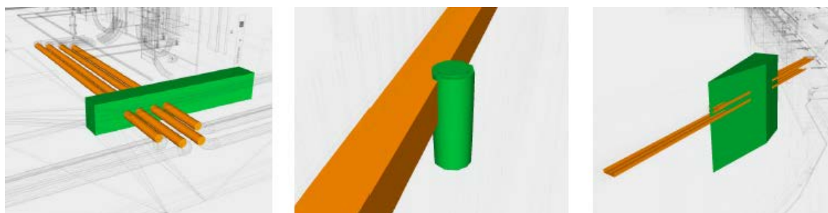
Imagen 2: Ejemplo de interferencias de instalaciones
