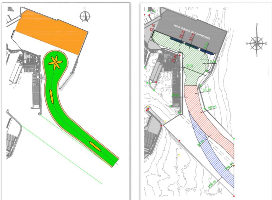
Figura 8. Espacios requeridos para las maniobras. Estudio previo (izquierda) y simulación con autopiloto (derecha)
