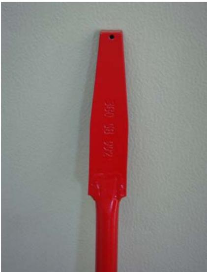
NOTA.- Una vez encajada la barra de accionamiento, el modo motorizado queda inutilizado, solo se podrá usar si se extrae la barra. Únicamente se puede cambiar la posición de las agujas con la barra específica para este uso, ya que por su forma y dimensiones toca un sensor que actúa desactivando el modo motorizado.
