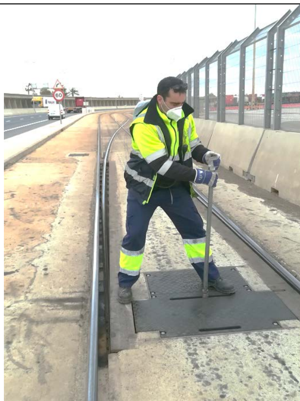
Imagen de un cambio enterrado con mecanismo de muelles, accionado por barra. Talonable.
