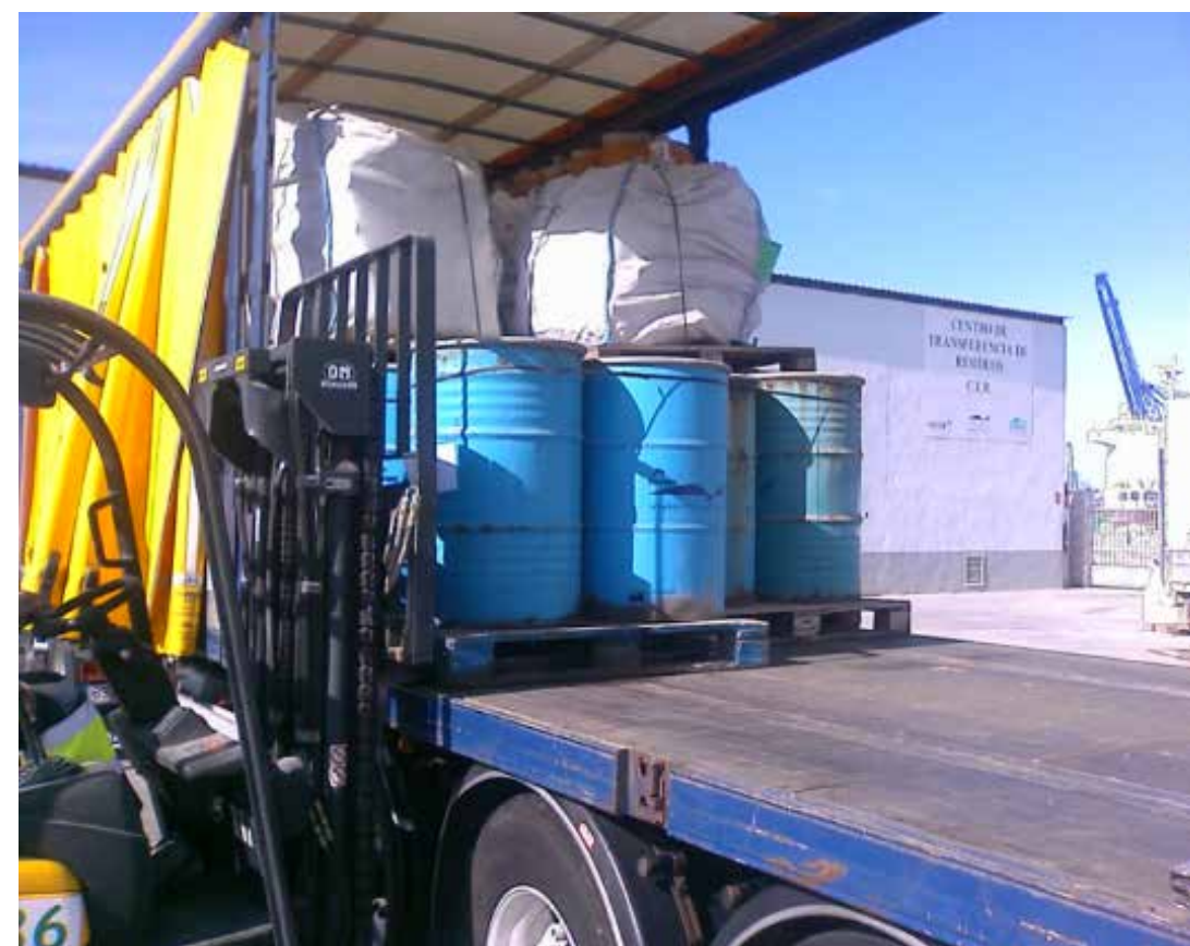
Detalle de trabajos de carga de los recipientes que contienen RP's al tráiler que posteriormente será descargado en una planta de destino final
