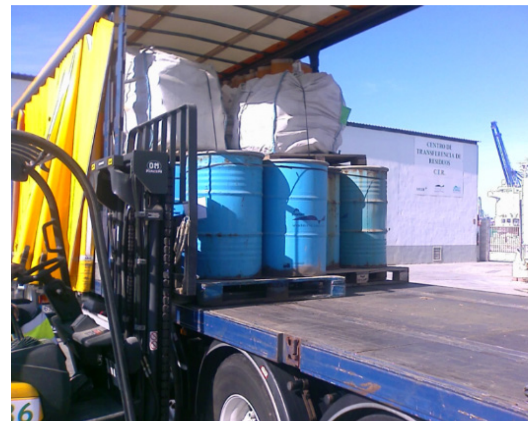
Detall de treballs de càrrega dels recipients que contenen RP's al tràiler que posteriorment serà descarregat en una planta final
